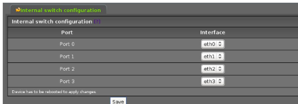
В стандартной конфигурации каждый физический порт соответствует своему сетевому интерфейсу. Назначение портам Port 0 и Port 1 одного интерфейса, к примеру eth1, сделает возможным передачу трафика между этими интерфейсами на втором уровне, т.е. как в стандартном коммутаторе.
