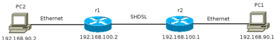
В приведенном выше рисунке мост состоит из двух интерфейсов — Ethernet-интерфейса eth0 и SHDSL-интерфейса dsl0 — и объединяет в одну сеть компьютеры PC1 и PC2.
