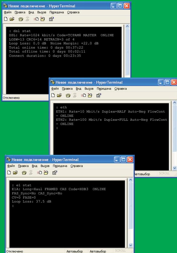
Программа управления позволяет задавать режимы работы по каждому интерфейсу и вести по ним сбор статистики, использовать тестовый режим для определения коэффициента ошибок, а также выполнять конфигурирование удаленного модема. Во всех случаях пользователь может гибко распределить пропускную способность канала SHDSL между используемыми интерфейсами с шагом 64Кбит/с для каждого интерфейса.
